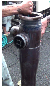
図-5 疑似汚れ配管
